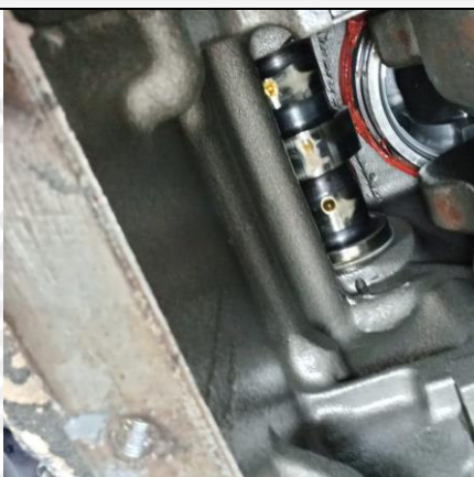
Camisa montada con exceso de sellador
