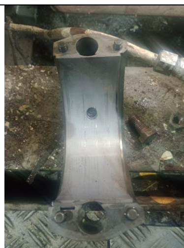
Inspección de cojinetes en generador de babor
