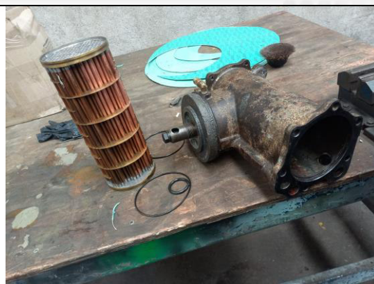
Desarme de intercambiador
