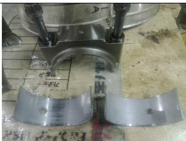
Inspección de cojinetes en generador de babor
