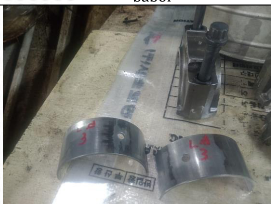
Inspección de cojinetes en generador de babor
